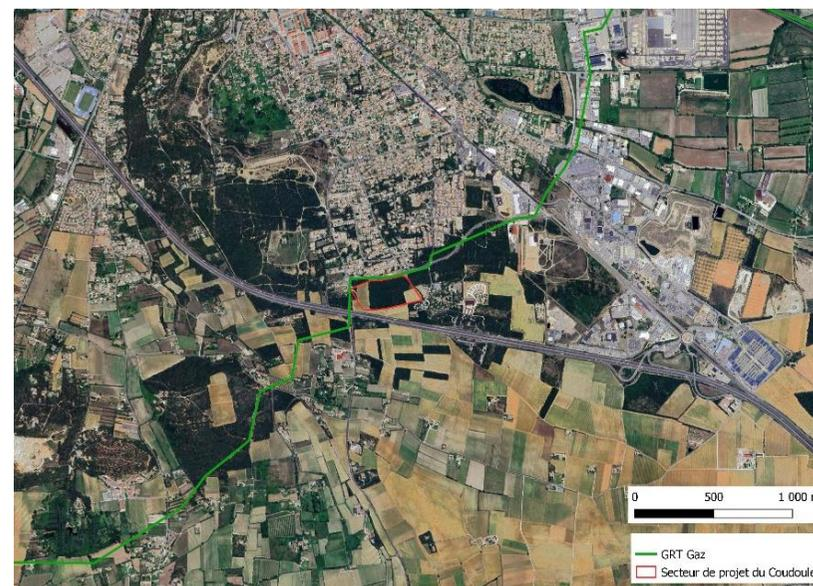
Figure 53 : Localisation de la canalisation GRT DN 150 (Source : Géorisque)
