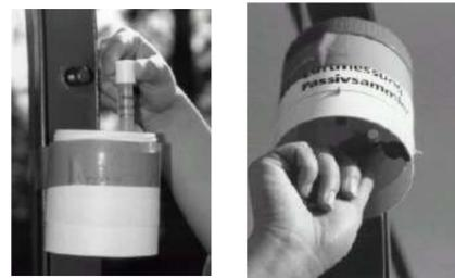
Figure 3 : Illustration de l'installation des tubes passifs - NO<sub>2</sub>
