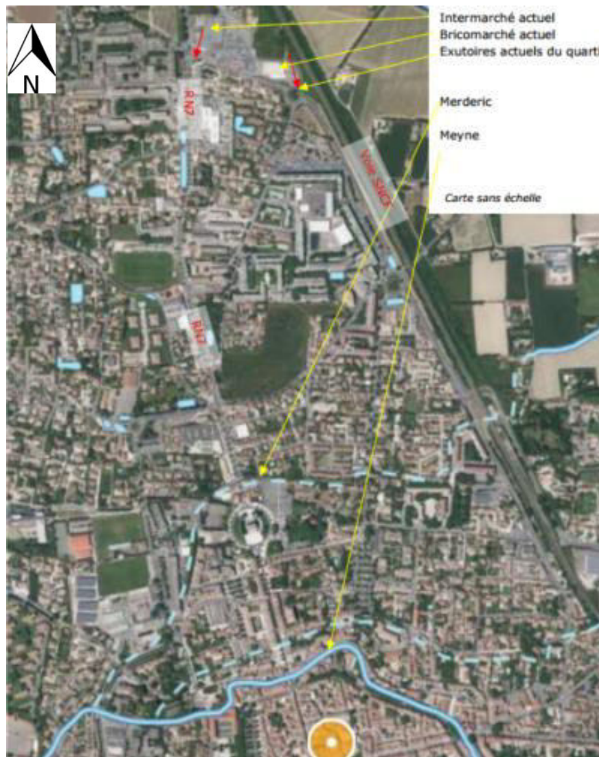
Figure 36 : Description des exutoires intermédiaires et finaux des eaux pluviales de l'aire d'étude (source : Alpha Conseil, 2024)
